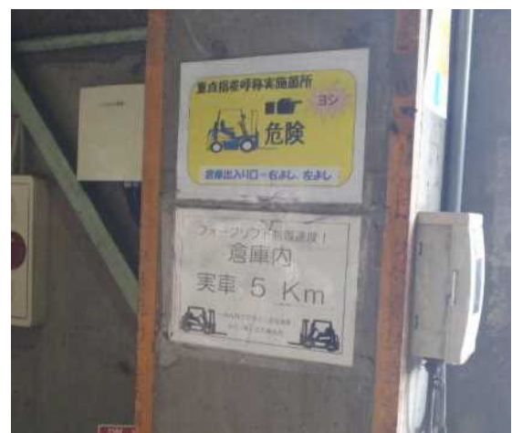
倉庫内制限速度, 指差ポイント明示
