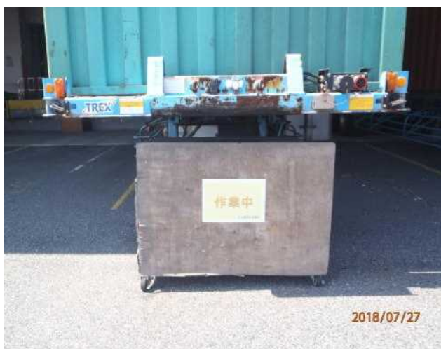
接触事故防止のための作業中の表示
